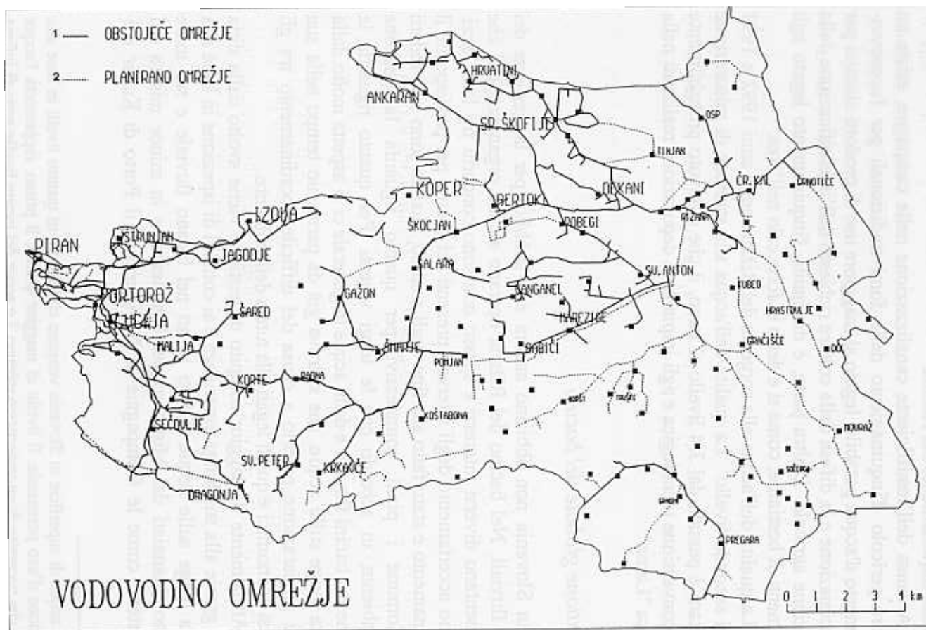
Fig. 5 – Rete di approvvigionamento idrico. 1. Esistente 2. Pianificata
